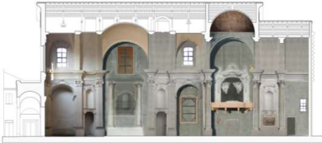
Figura3. Progetto di parziale risarcimento delle lacune mediante integrazioni materiali e videoproiezioni
